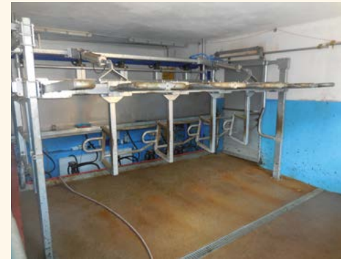
Platzsparender, einfacher Side-by-side Melkstand
