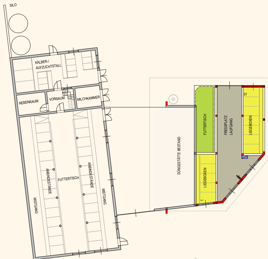
Grundriss – nach der Baumaßnahme
