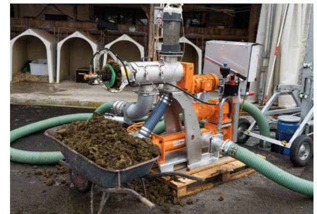
Ein Gülleseparator kann zur Emissionseinsparung im Bereich der Ausbringung beitragen. Das erzeugte Feststoffseparat kann unter bestimmten Bedingungen auch als Einstreu in Tiefboxen verwendet werden.
