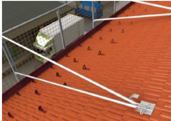
Dachschutzblende mit Fußwehr und Rückverankerung (bis 60° Dachneigung)
