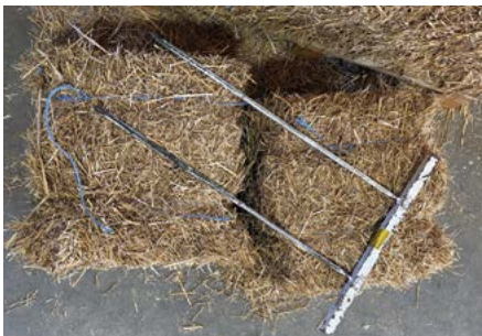
Strohnadel mit abgebundenen Strohballen (Hohensinner)
